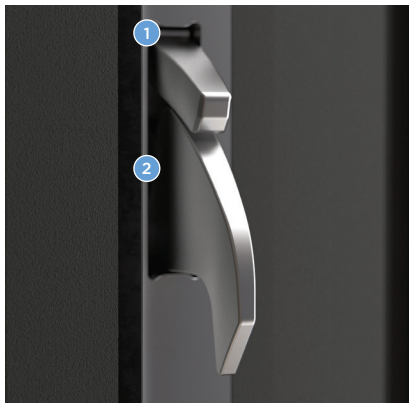
Дверь закрыта: Уплотняющий ригель активируется, ригель-клык выдвигается и фиксируется в раме.
